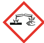
Corrosione (elementi corrosivi)
